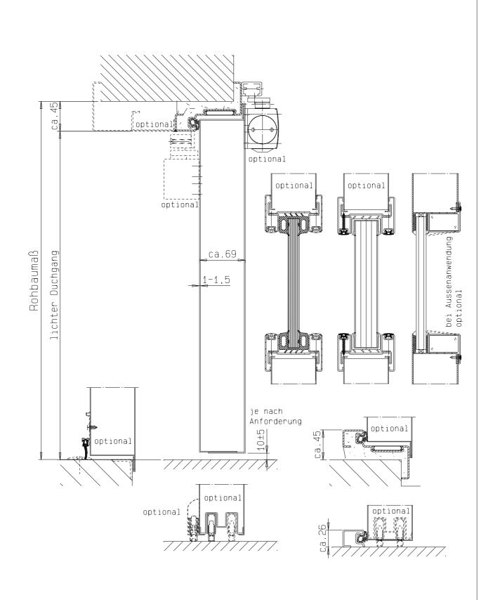
Einbau- bzw. Zargenvarianten siehe Horizontalschnitt
